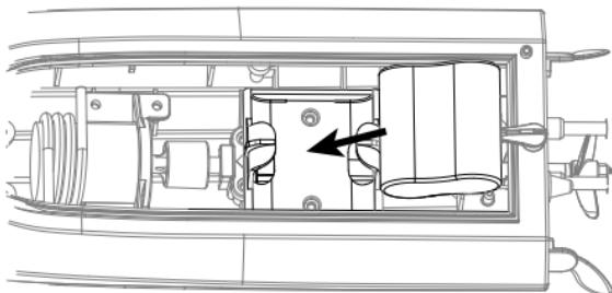
④ 将电池输出端口与船身输入端正确连接。
