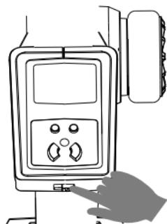
确认遥控器的油门扳机、转向旋钮回位正常。
