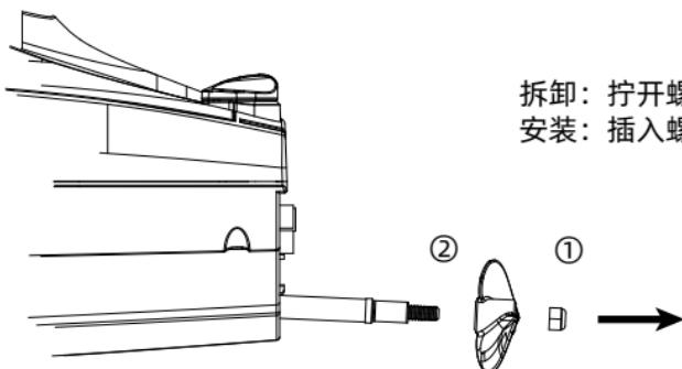
拆卸：拧开螺母，取出螺旋桨。
