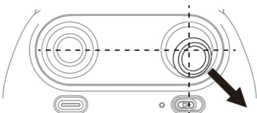
对频成功后，遥控器右控制杆推向右下角45°，飞行器航灯快闪后变为长亮，表示陀螺仪校准完毕。松开右控制杆。
