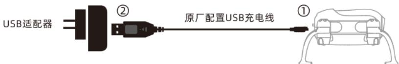
▲ 仅使用原厂配置充电线，建议选择输出为5V 2A电流的适配器。
