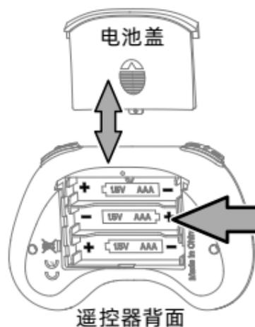
打开遥控器背面的电池盖，按照电池盒内指定的电池极性方向正确安装电池。
