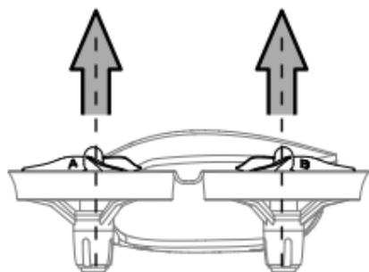
按住电机，以垂直电机的方向向上拔出桨叶。
