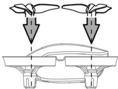
桨叶的中心孔对准电机轴垂直电机方向向下压入桨叶。
