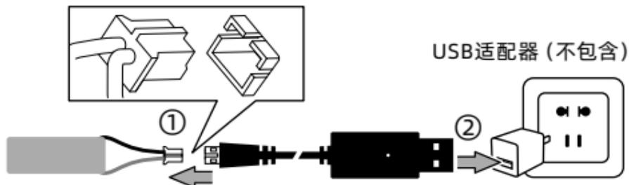
▲ 请使用设备随附的USB连接线并确保连接正确
