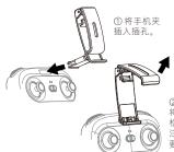
② 拉开手机夹上夹口, 将手机放置上下夹口中, 松开上夹口, 夹紧手机。 注意手机侧面的按键不 要被夹到。
