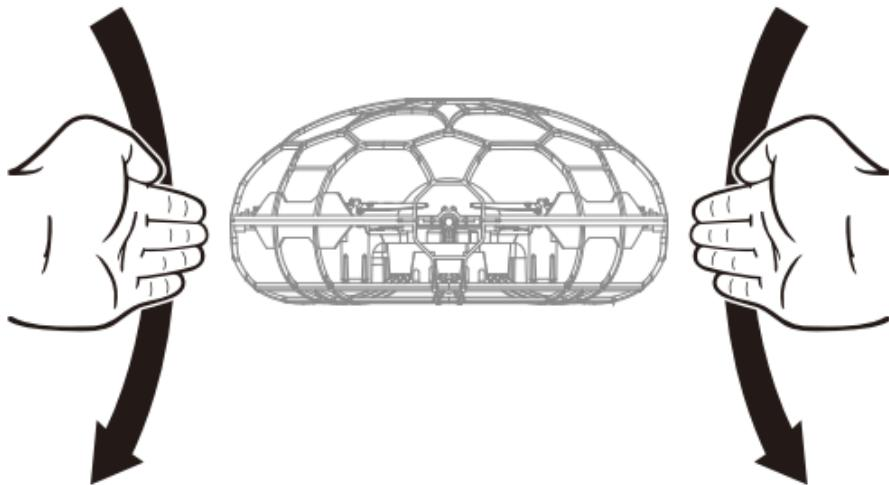
**注意：当飞行器受到撞击或不正常跌落时，有可能导致陀螺仪不能复位，从而使飞行器难以控制。此时需重新打开电源对飞行器进行校正。**
