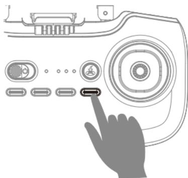
按一下“H/L”键，发出“di.di.di”声音，进入高速模式“H”；再次按一下，发出“di”声音，进入低速模式“L”；再次按一下，发出“di.di”声音，进入中速模式“M”。
